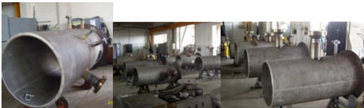
**Projekt Rosneft Propene/Propylen Anlage:** Gaskühler (Leistung je 3,5MW) und Abscheider
