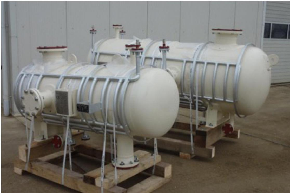
Pulsationsdämpfer für Sauer gas Anwendung mit Heizspirale
